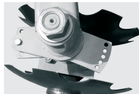
Regulagem de ângulo dos discos da grade cultivadora/incorporadora. Angle adjustment for the discs of the harrow. Calibración de ángulo de los discos de la rastra cultivadora/incorporadora.
